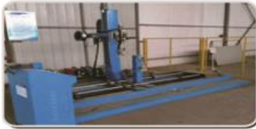
环直缝氩弧焊机 Φ 1500 × 3000 × 8
