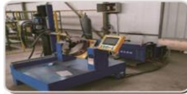
管法兰氩弧焊机，Φ 300
