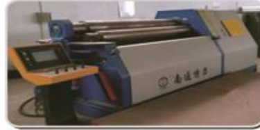
数控四辊卷板机 1500 × 12无预弯、无直段一次成型
